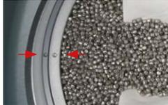
3. Geräteformtopf muss frei von z. B. Granulat sein, den Modelltopf mit Modell einsetzen. Der Modelltopf rastet ein, wenn die Markierungspunkte ausgerichtet sind (Pfeile).
