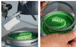
10. Nach der Abkühlzeit den Okkludierbügel ganz öffnen und den Folienspannring lösen.
