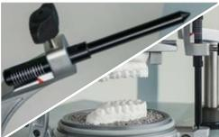
5. Den Stützstift auf die breitere O-Linie einstellen. Okkludierbügel schließen (Modellkollision vermeiden). Zur Modellartikulation die obere Modellplatte halten ...
