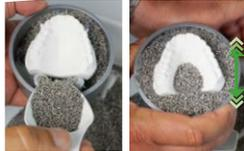
2. Der abzuformende Modeltteil muss über den Topfrand ragen. Topf mit Granulat füllen, Topf schüttern, damit auch Granulat unter das Modell gelangt.
