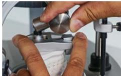
7. Halten und das Arretiergelenk fest schließen. Steht kein Konstruktionsbiss zur Verfügung, kann der Biss mit dem Stützstift angehothen werden (siehe Tipp).
