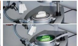
8. Okkludierbügel öffnen. Tiefziehen, sobald die Folie angeformt ist, den Okkludierbügel schließen.
